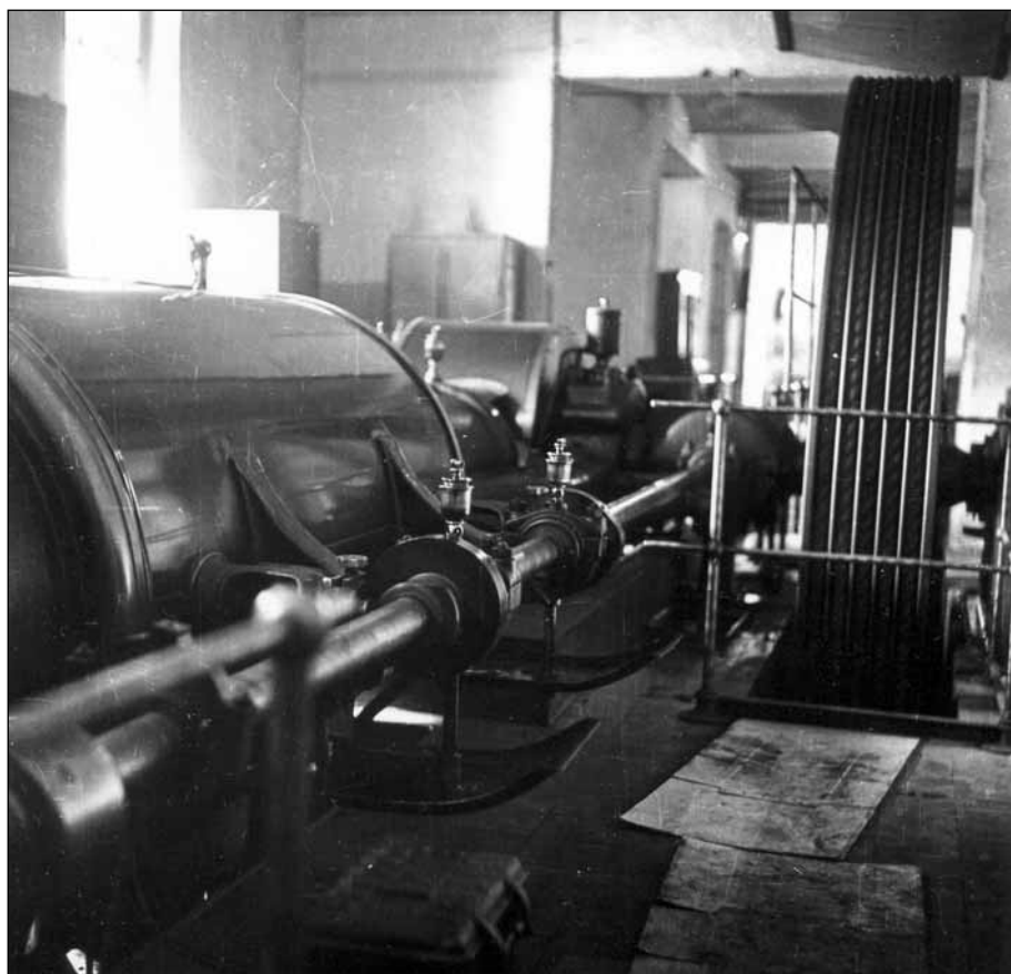
Pohled na zadní stranu nízkotlakého válce, rozvodovou hřídel, pomocné ventily a setrvačnick parního stroje rapotínské sklárny, 1968. (foto Karel Miloš)
